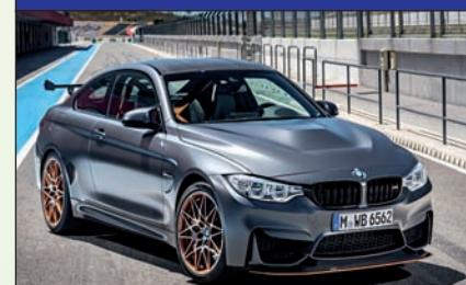
La M4 GTS è la prima vettura stradale di BMW a sfruttare «l'iniezione ad acqua», una soluzione tecnica che grazie all'acqua immessa negli iniettori abbassa la temperatura nella camera di combustione; ciò consente dunque di migliorare il rendimento perché possono essere usati rapporti di compressione più «spinti». Infatti il turbo a sei cilindri sale a 500 cavalli di potenza e il tempo sullo 0-100 chilometri orari è di 3,8 secondi e raggiunge una velocità massima di 305 chilometri orari.
